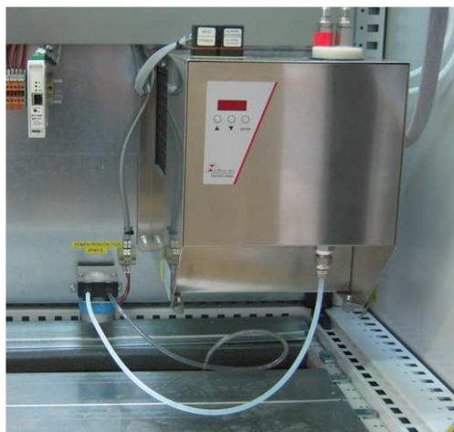
Figura 4: Refrigeratore a singolo scambiatore e pompa peristaltica.
