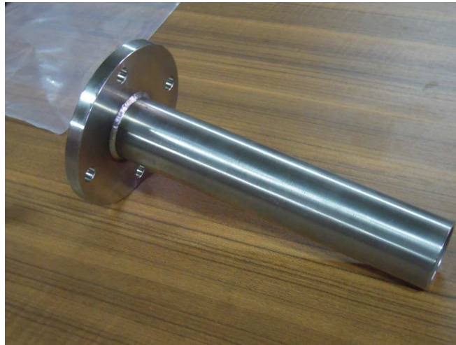
Figura 13: Bocchello flangiato DN65 PN6 per fissaggio della sonda riscaldata mod. 7030 (non compreso nella fornitura).
